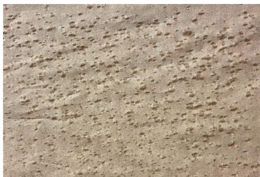
Figur 2 Vattenfläckar på sugande papper efter cirka två sekunders exponering för simulerat slagregn.
