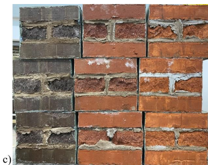
Figur 3. Provkroppar som användes i de två experimentella undersökningarna; a) exponerad sida; b) fogtyper; c) skyddad sida.
